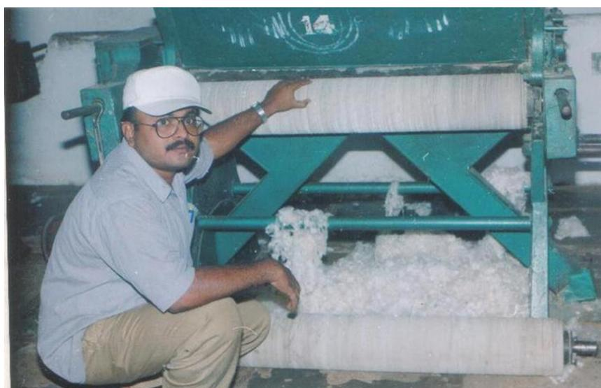
**FIGURE 6: UNSAFE CHROMIUM COMPOSITE LEATHER CLAD ROLLERS COMMONLY**
